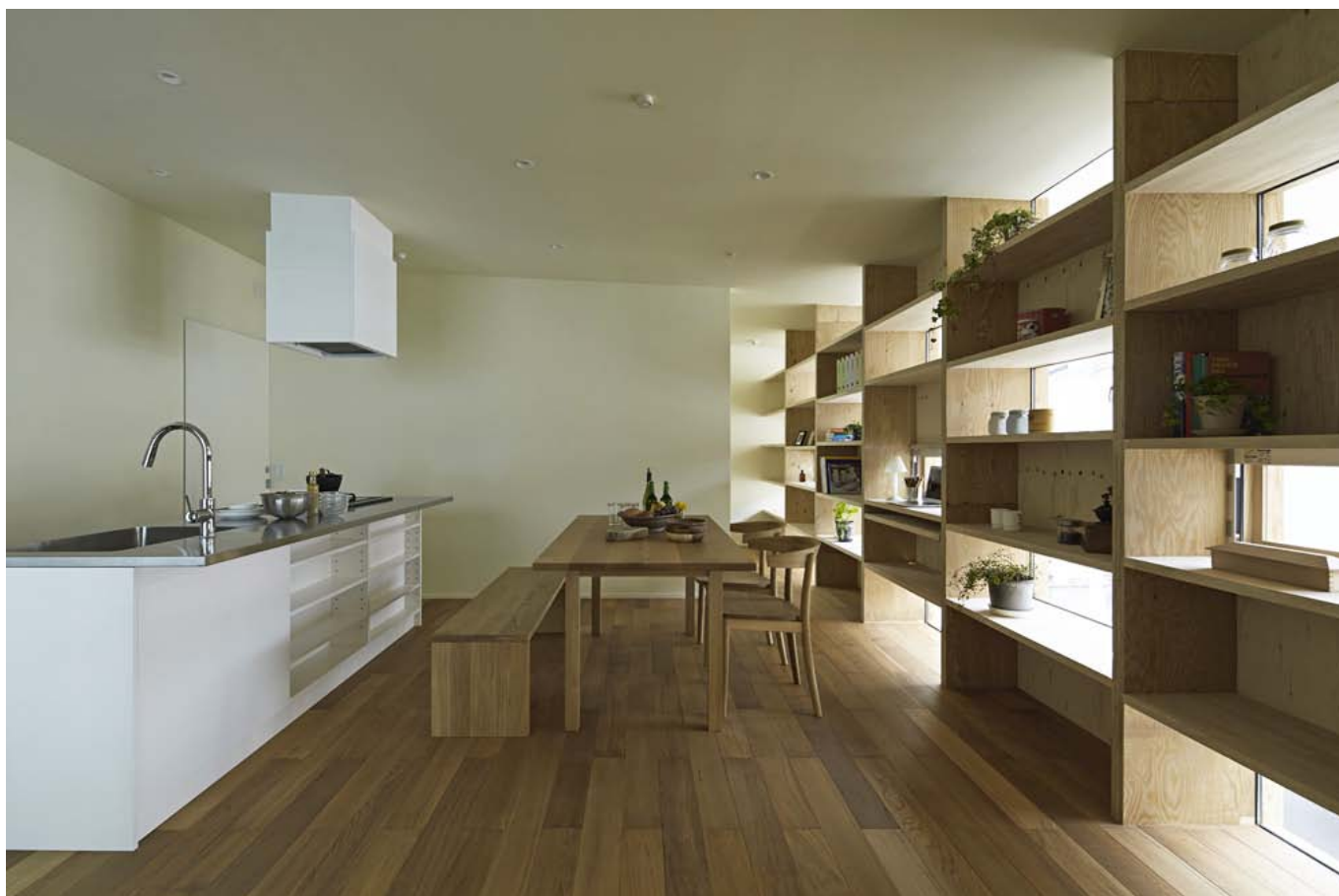
2階リビングダイニングキッチンから主寝室方向を見る。床はチークフローリング。壁面は僅かに黄色を加えた水性塗料。キッチンは家具屋にて特注製作。
