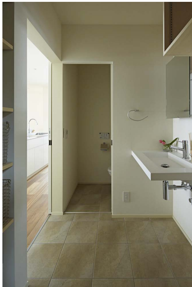
2階洗面室・トイレは必要最小限の広さとしています。床は磁器質タイル。左に可動棚を設置しています。
