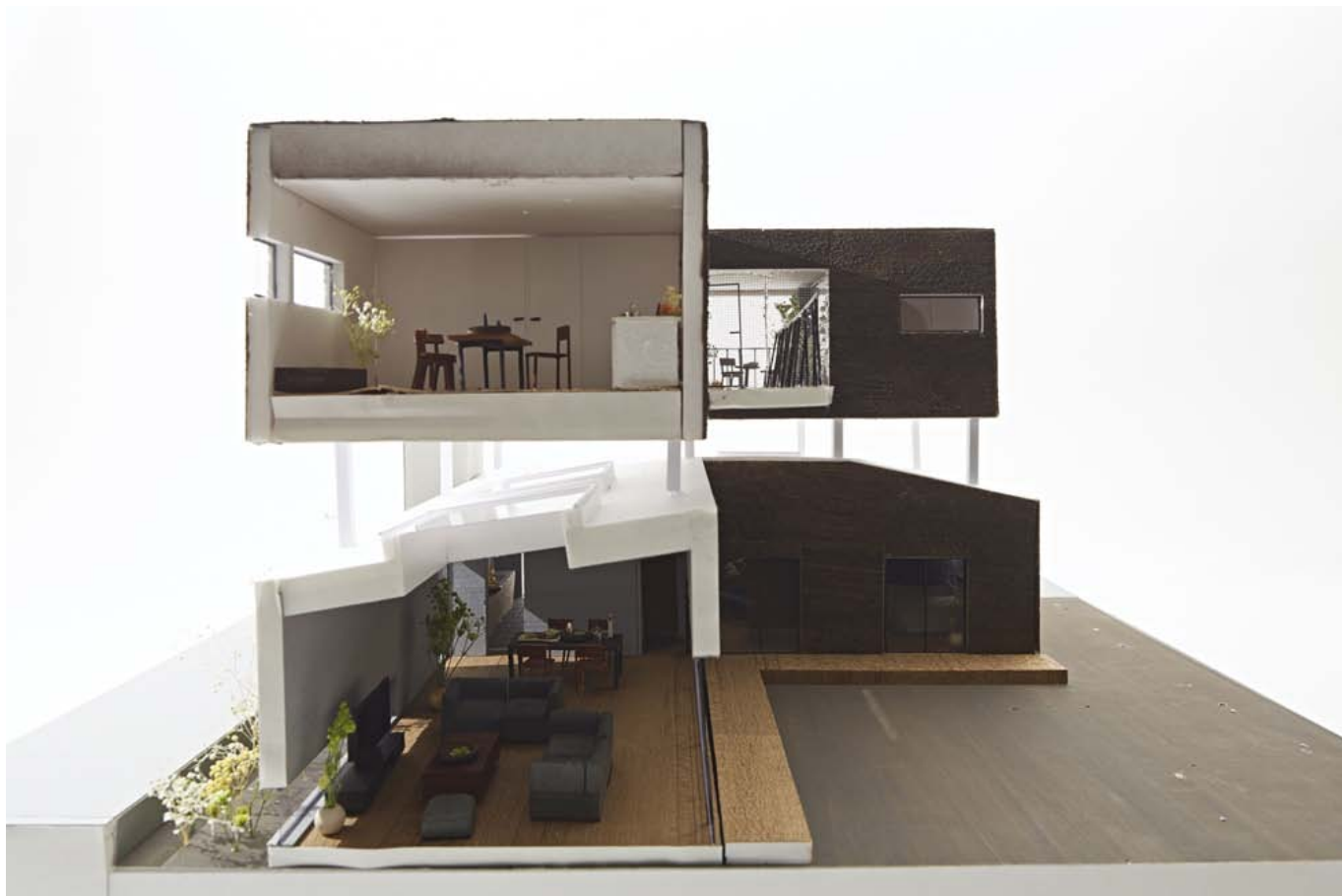
プレゼンテーションで使用した模型の断面写真 2階部分を持ち上げることで、生活音が下階に伝わるのがなくなり、2海の眺望も豊かになります。
